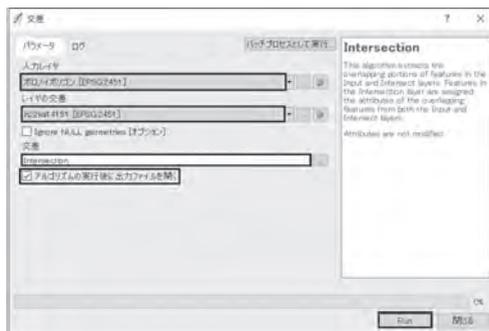
では「ボロノイポリゴン」を、「クリップされた」に、ここでは「Realm」<sup>22)</sup>と入力する。「アルゴリズムの実行後に出力ファイルを開く」にチェックが入っているのを確認し、「Run」ボタンを押す(図表 IV-10)。レイヤパネルに「クリップされた」というレイヤが追加されるので、名称を「Realm」に変えておく。クリップされた各地区の面積を算出するために、メインメニューの「ベクタ」「ジオメトリツール」「ジオメトリカラムの出力/追加」を選び、「ジオメトリカラムの出力/追加」ウィンドウを出す。「パラメータ」タブの「入力レイヤ」では「Realm」を、「計算に利用する」では「レイヤ CRS」を選び、「追加された地形
