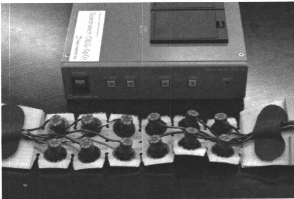
図 1 実験で使用した fNIRS (機能的近赤外分光装置)*
