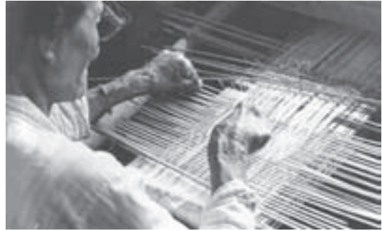
(図9) 文様をだす経糸をすくった細棒を糸綜統に置き替えている (バリ島)
