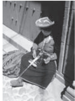
(図5) 簡易な後帯機を自分の足に掛け、経糸に張りを持たせて織っているアンデスの女性 (ペルー)
