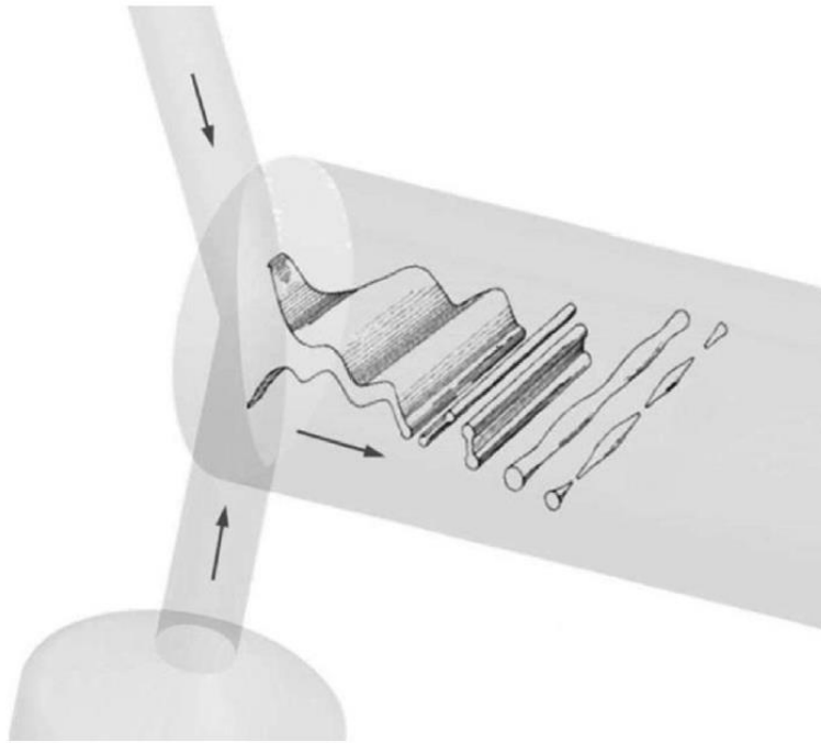
図 1.4 Y 字ミキサにおける非定常混合挙動(Metzger and Kind, 2015)
