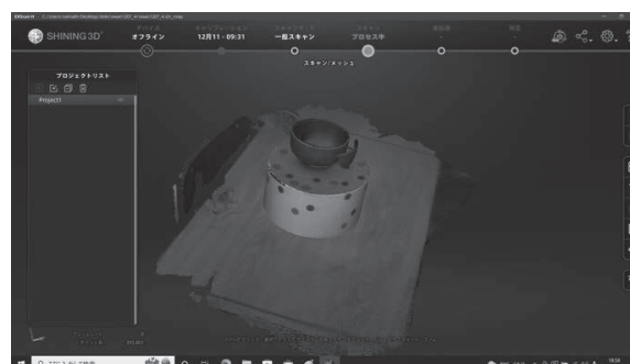
図6 台座を用いたスキャン
