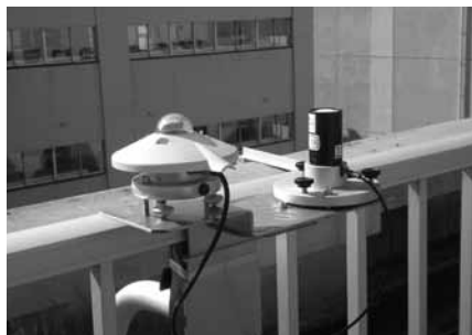
図 1 全天日射計 (左) と B 領域紫外域日射計: 東西に並べて、受感面の高さを等しくしてある
